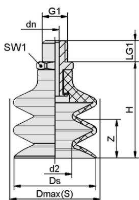
Datos de diseño FSG 3 NBR-ESD-55 M3-AG
