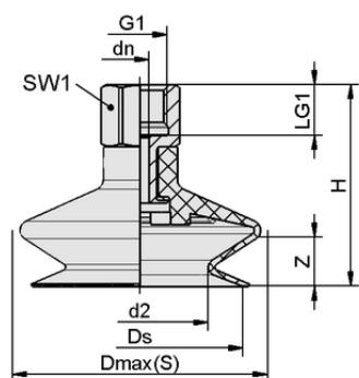
Dati di costruzione FSGA 11 NBR-ESD-55 G1/8-IG
