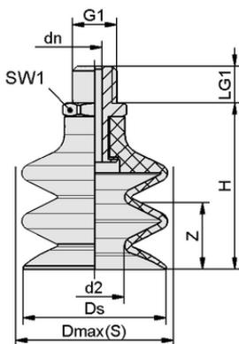
Dati di costruzione FSG 14 SI-HD-65 M5-AG
