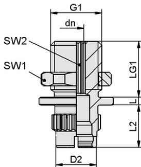
Dati di costruzione SC-A 045-AR M10-AG L
