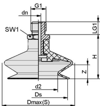
Données de construction FSGA 6 NBR-55 M5-AG
