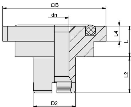
Dati di costruzione SC-A 055 RA L
