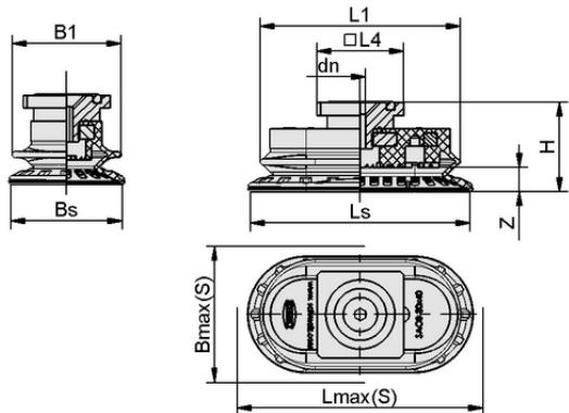
Dati di costruzione SAOB 140x70 NBR-60 RA
