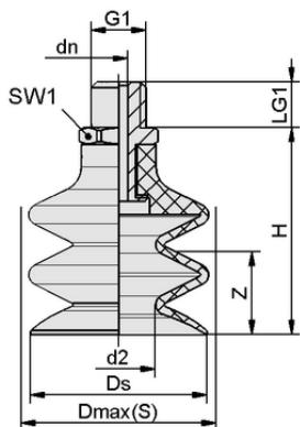
Konstruktionsdaten FSG 62 NK-45 G1/4-AG
