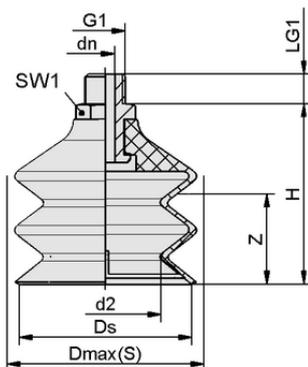
Données de construction FSG 85 VU1-72 G1/4-AG ON
