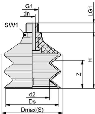
Dati di costruzione FSG 85 VU1-72 G1/4-AG ON
