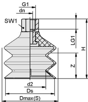
Dati di costruzione FSG 30 VU1-72 G1/4-IG
