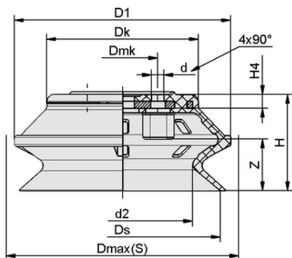
Dati di costruzione FGA 150 NBR-70 N010
