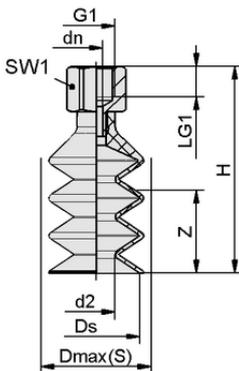
Datos de diseño FSGB 25 NBR-55 G1/8-IG
