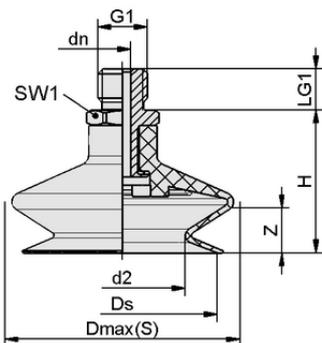
Datos de diseño FSGA 11 NBR-55 M5-AG
