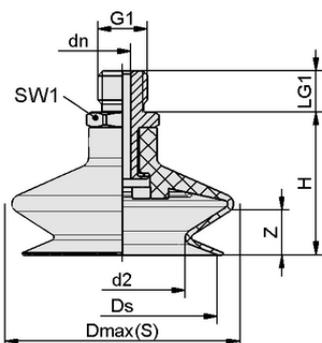
Données de construction FSGA 11 NBR-55 M5-AG
