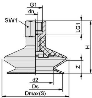
Datos de diseño FSGA 11 NBR-55 G1/8-IG
