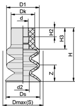
Dati di costruzione FG 14 NBR-55 N016
