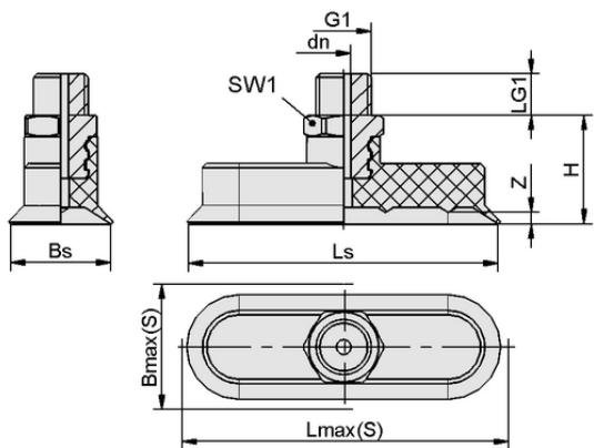
Dati di costruzione SGON 30x10 NBR-ESD-55 G1/8-AG
