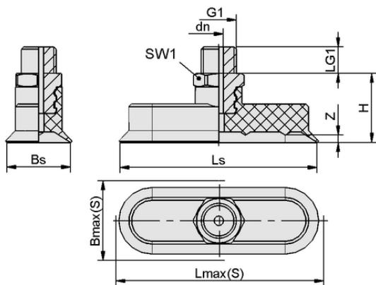
Dati di costruzione SGON 12x4 NBR-ESD-55 M5-AG
