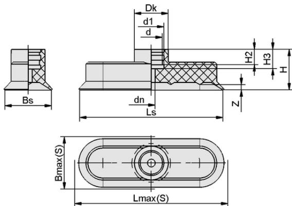
Données de construction SGO 18x6 NBR-ESD-55 N021
