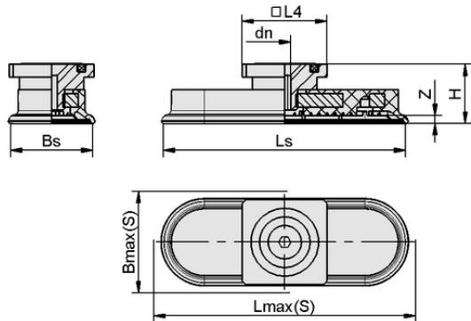
Données de construction SAOF 100x50 NBR-45 RA
