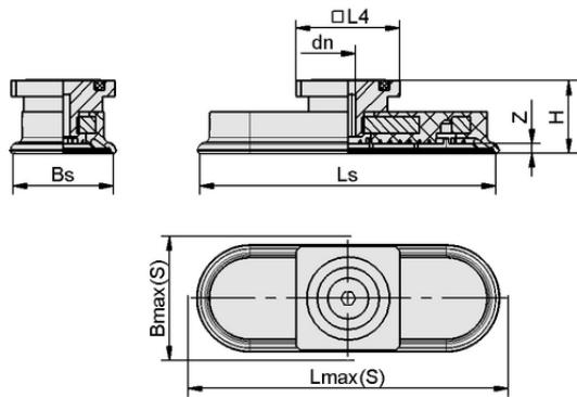
Dati di costruzione SAOF 80x40 NBR-45 RA
