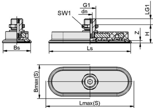
Datos de diseño SAOF 90x30 NBR-45 M14x1.5-AG
