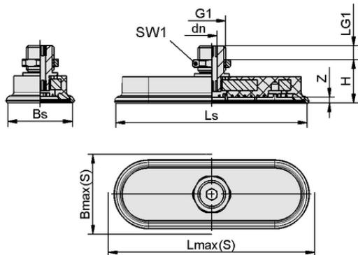
Données de construction SAOF 60x23 NBR-45 M10-AG
