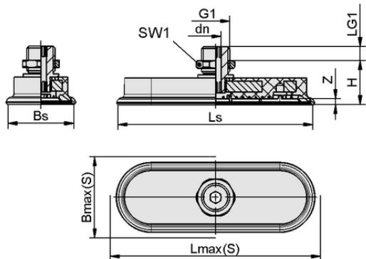
Dati di costruzione SAOF 60x23 NBR-45 M10-AG
