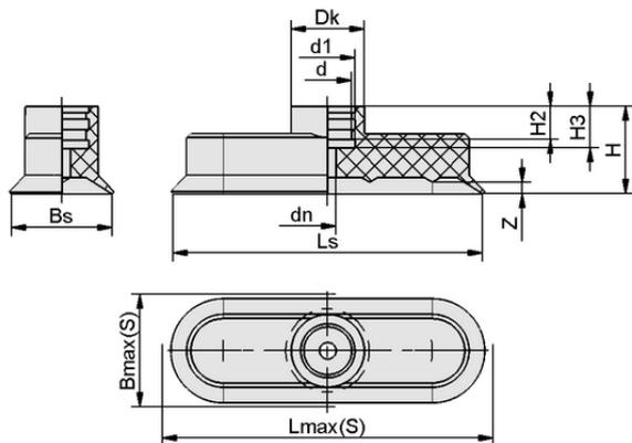
Dati di costruzione SGO 45x15 HT1-60 N023
