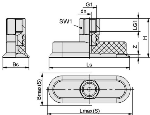
Données de construction SGON 60x20 NBR-55 G1/4-IG
