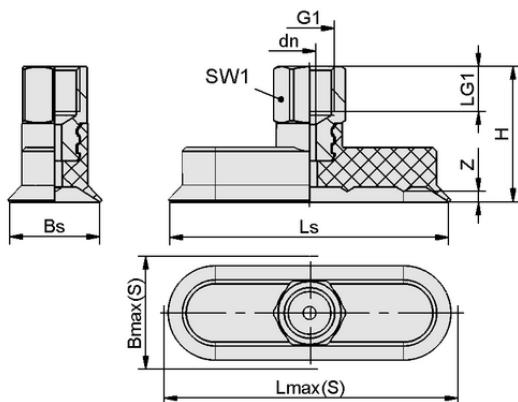
Dati di costruzione SGON 60x20 NBR-55 G1/4-IG
