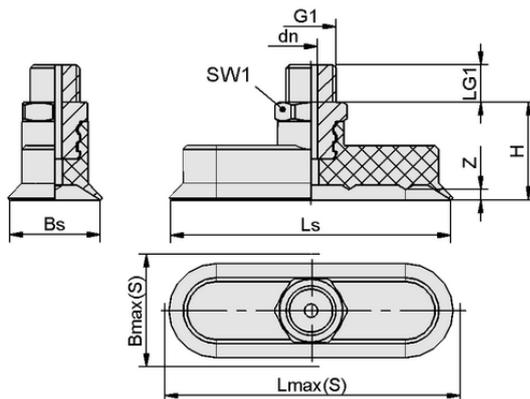
Datos de diseño SGON 75x25 NBR-55 G1/4-AG
