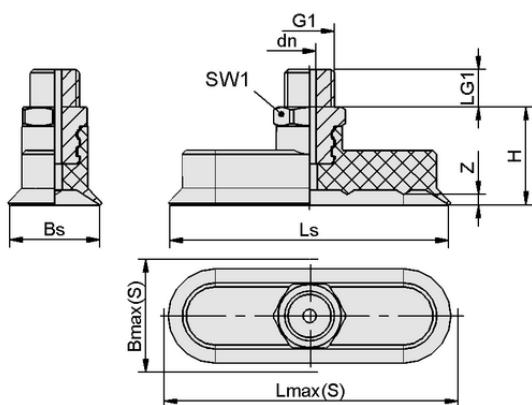
Dati di costruzione SGON 90x30 NBR-70 G1/4-AG
