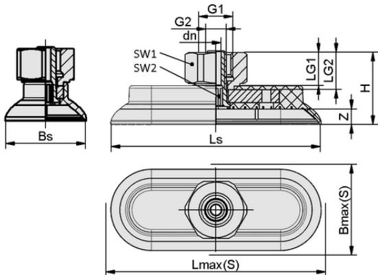
Dati di costruzione SAOG-S 95x40 NBR-60 G1/4-IG MOD
