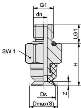
Dati di costruzione SUF 6 SI-55 M5-AG
