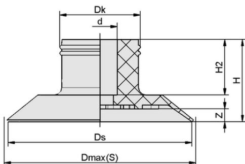
Dati di costruzione SGP 15 FPM-65 N016
