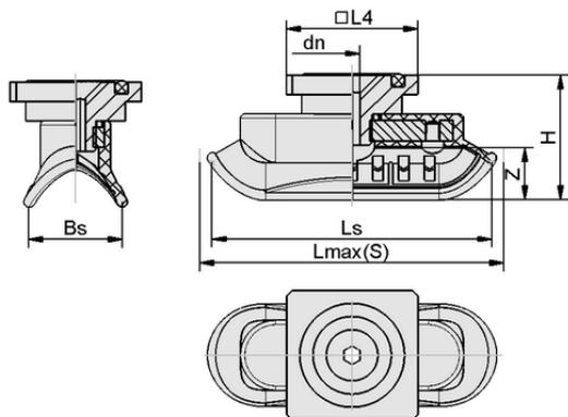
Données de construction SAOK 70x25 NBR-60 RA
