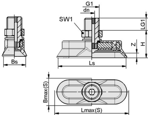
Dati di costruzione SAOG 95x40 NBR-45 G1/4-AG
