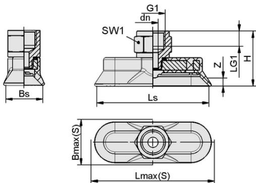
Dati di costruzione SAOG 95x40 NBR-45 G3/8-IG
