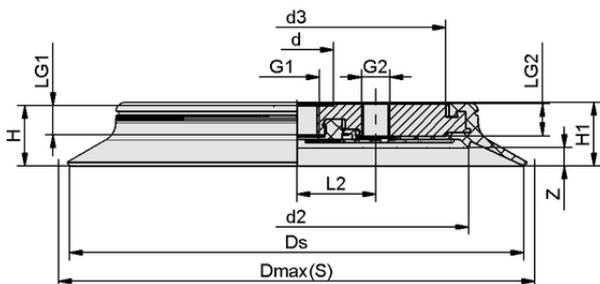
Données de construction SPU 250 NBR-55 G1/2-IG B
