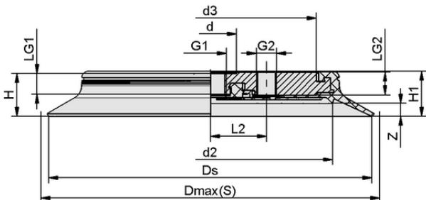
Datos de diseño SPU 210 NBR-55 G1/2-IG B
