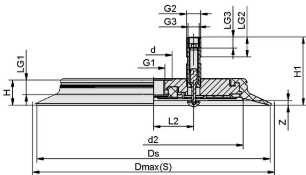
Konstruktionsdaten SPU 250 NBR-55 G1/2-IG TV
