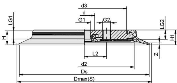
Dati di costruzione SPU 210 SI-60 G1/2-IG AE
