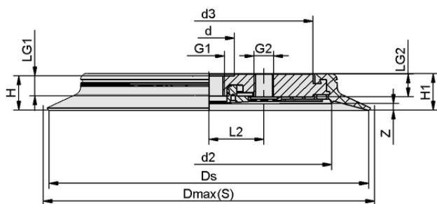
Datos de diseño SPU 210 SI-60 G1/2-IG AE
