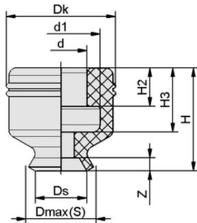
Dati di costruzione PFG 2 NBR-55 N003
