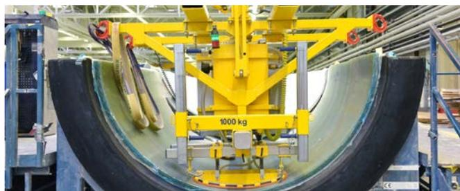
Transport des Flanschelements zum Einsetzen
