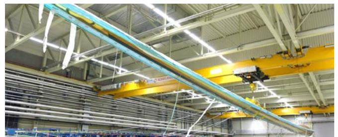
Transport des Rotorblatts mit Tip-Entformgerät
