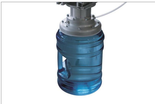
Bottle Rack Loader SBRL bei der Handhabung einer Wasserspenderflasche
