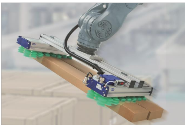
Vakuum-Flächengreifsystem FXP beim der Handhabung von Kisten
