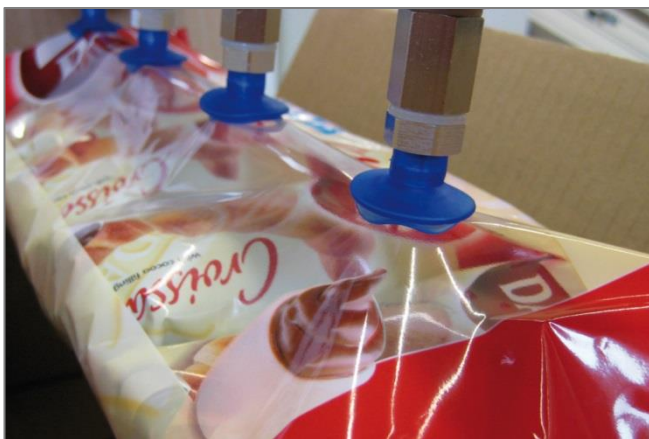
Balgsauger FGA PVC bei der Handhabung von biegeschlaffen Werkstücken
