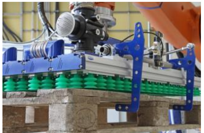
Palettenklemmung des Lagengreifsystems im Einsatz
