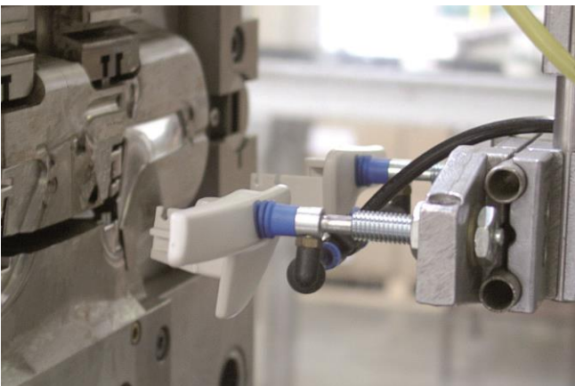
Balgsauggreifer FSG bei der Handhabung von heißen Kunststoffteilen
