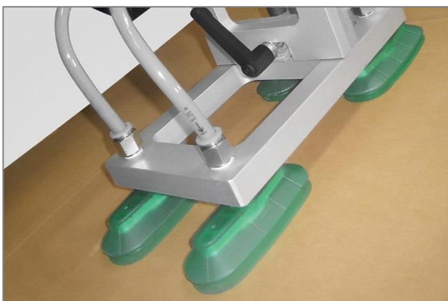
Balgsauger SPOB1 bei der Handhabung von Kartonagen
