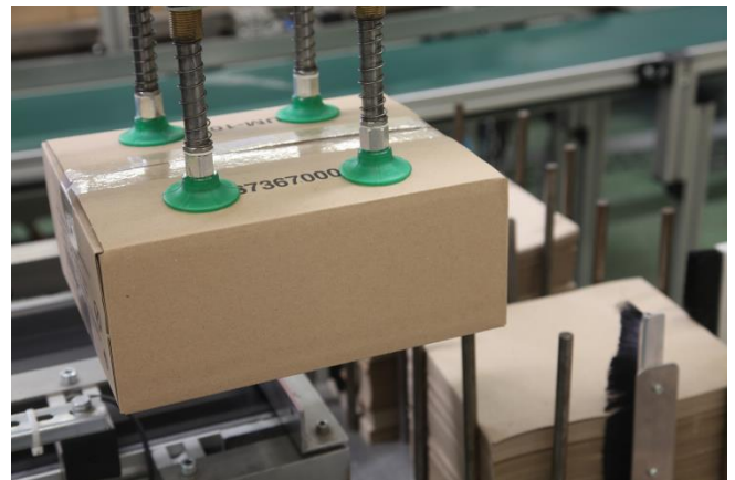
Balgsauggreifer SPB1 zur Handhabung von verschlossenen Kartons
