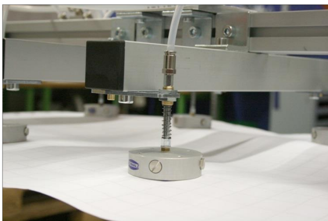
Schwebesauger SBS bei der Handhabung von dünnem Papier
