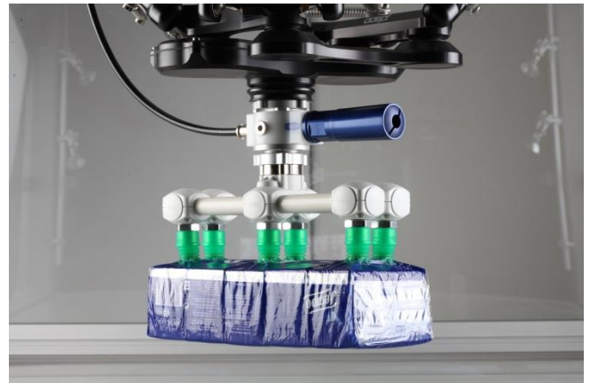
Vakuum-Endeffektor VEE zur Handhabung von Beuteln
