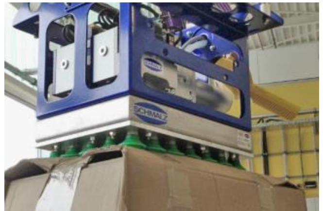
Lagengreifsystem zur Handhabung von Kartons (individuelle Maße durch Aluminiumkonstruktion, Einschraubsauger)
