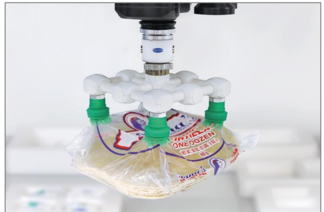
Vakuum-Endeffektor mit Balgsauggreifern SPB4f bei der Handhabung von Beutelverpackungen mit starker Faltenbildung und geringem Füllgrad
