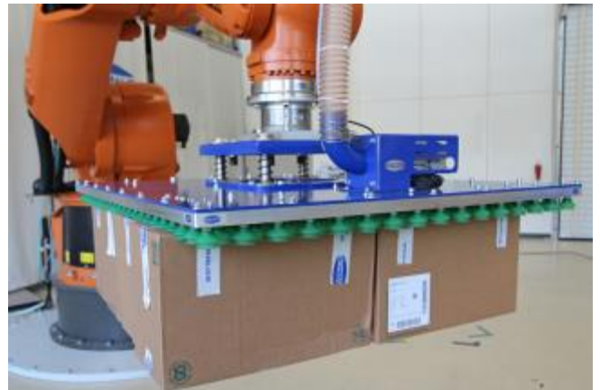
Lagengreifsystem zur Handhabung von Kartons (individuelle Maße durch Aluminiumkonstruktion, Einschraubsauger)
