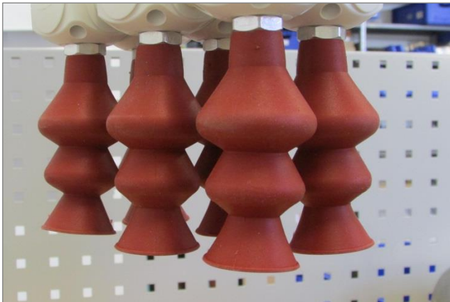
Balgsauggreifer FG-X im ausgefederten Zustand
