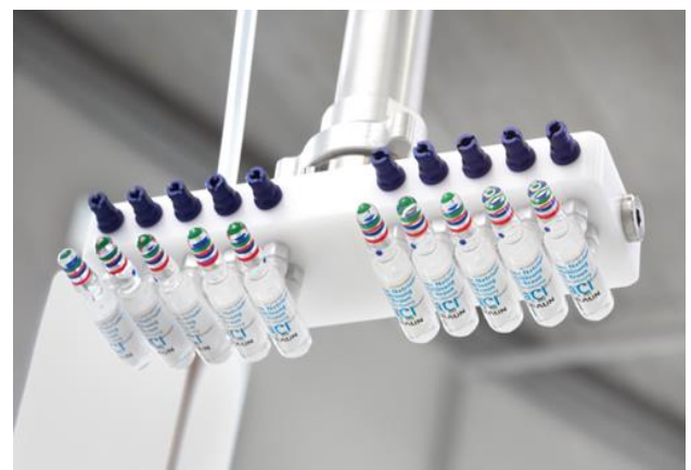
Vakuum-Endeffektor zur Handhabung primärverpackter Ampullen
