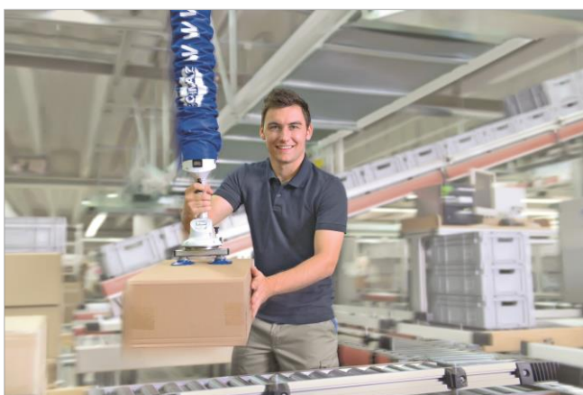
Vakuum-Schlauchheber JumboFlex bei der Handhabung von Modulen
