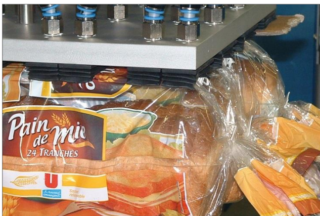
Balgsauggreifer FSGB-R bei der Handhabung von Verpackungen
