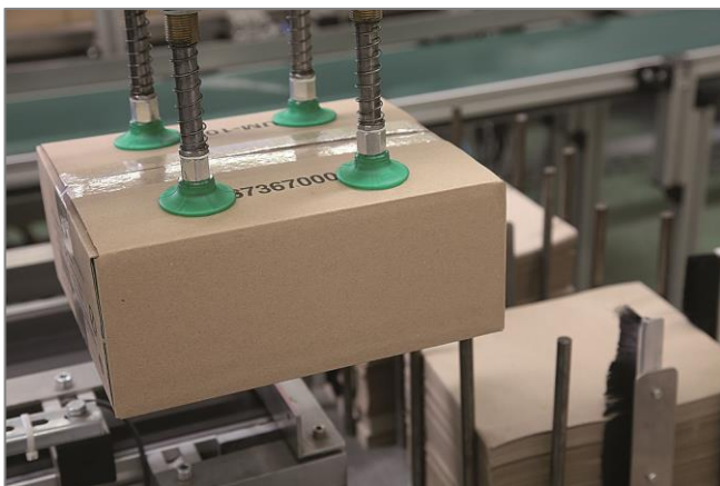
Balgsauger SPB1 bei der Handhabung von Kartonagen
