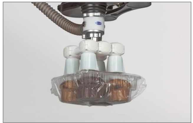
Vakuum-Endeffektor mit Balgsauggreifern SPB4 und Stabilisierungselementen bei der Handhabung von labilen Flow-Wrap-Verpackungen
