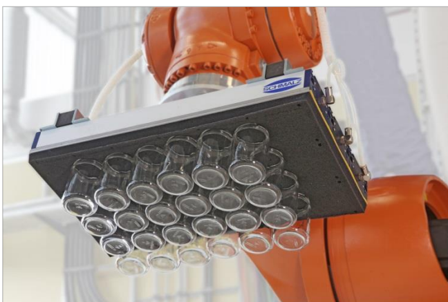
Vakuum Lagengreifsystem SPZ für die Handhabung von Gläsern
