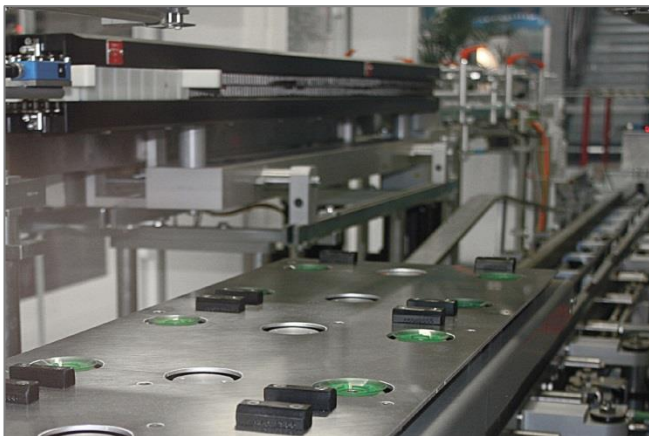
Flachsauger SPF beim Einsatz in einer Verpackungsmaschine
