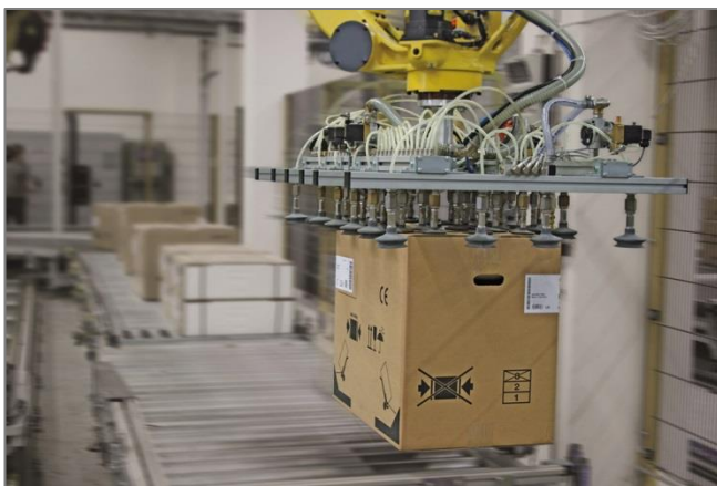
Balgsauggreifer FSGA bei der Handhabung von Kartons
