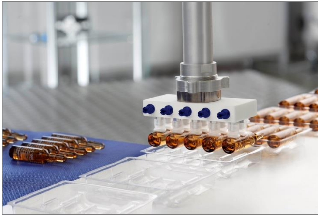
Dezentrale Vakuum-Erzeugung durch ecoPump SEP bei der Handhabung von Ampullen
