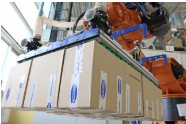
Lagengreifsystem zur lagenweisen Handhabung von Kartons und Paletten mit mehreren Saugzonen (verblockte Bauweise, Einstecksauger)
