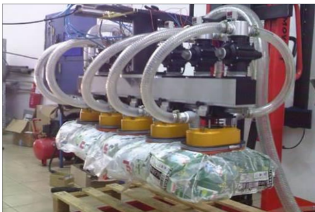
Sacksauggreifer SG zur Handhabung von Kunststoffsäcken
