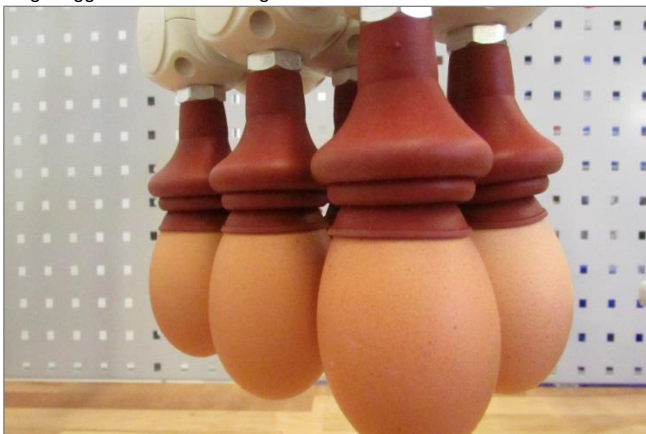
Balgsauggreifer FG-X auf rohen Eiern
