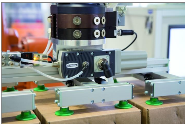
Zentrale Vakuum-Erzeugung durch den Grundejektor SBPL
