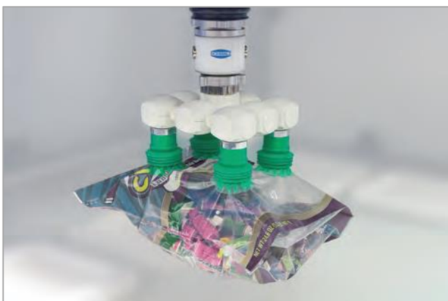
Balgsauger SPB4f bei der Handhabung von Beuteln
