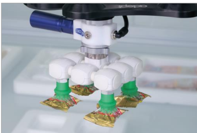
Balgsauger SPB2f bei der Handhabung von Beuteln
