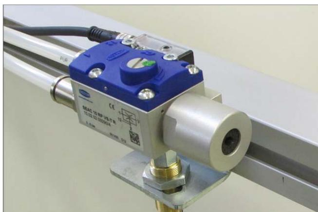
Ejektor mit Abwurfsystem SEAC direkt auf einem Federstößel montiert
