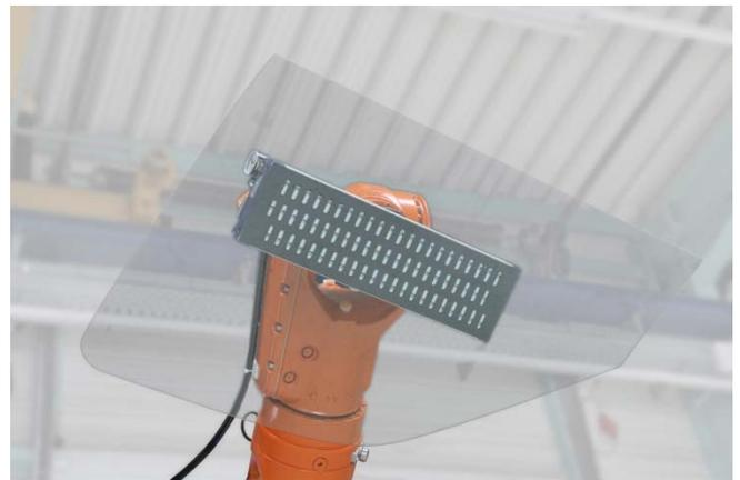
Vakuum-Flächengreifsysteem FXP bei der Automobilglas Montage
