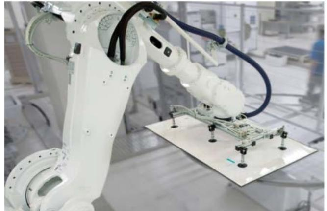
Vakuum-Saugspinne SSP beim Backsheet Layup von PV Modulen
