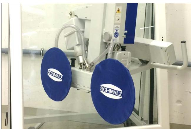
Sauggreifer-Schutzüberzüge PC beim Einsatz auf Saugplatten
