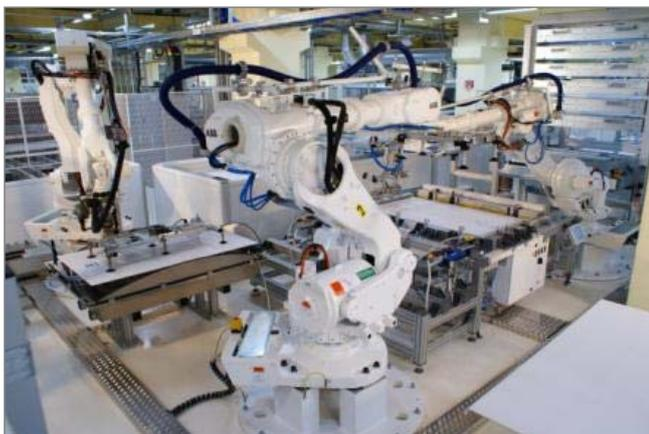
Vakuum-Saugspinne SSP in bei der Rahmung von Solar Modulen
