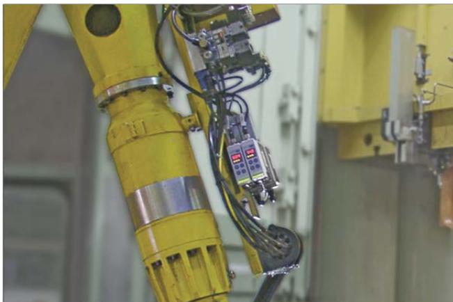
Kompaktejektoren X-Pump beim Beladen von Biegeöfen
