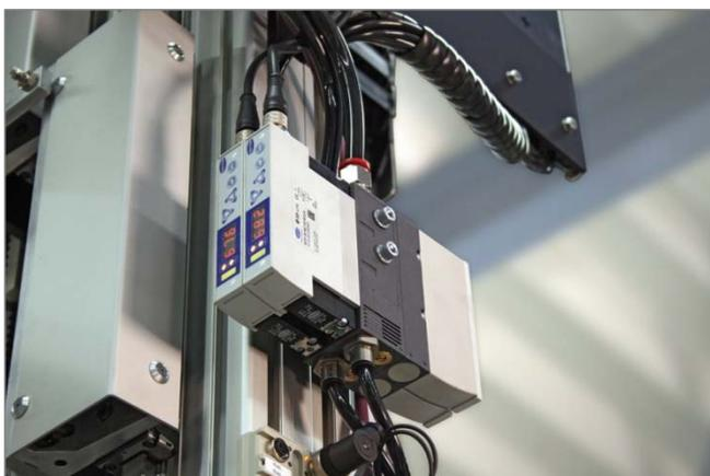
Zentrale Vakuum-Erzeugung durch Kompaktejektoren SMPi
