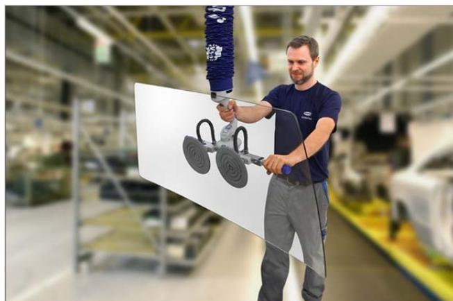
Vakuum-Schlauchheber JumboFlex beim Handling von Frontscheiben
