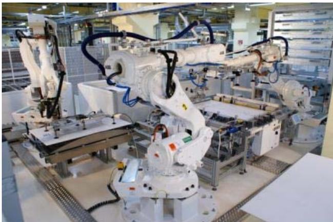
Vakuum-Saugspinnen SSP beim Rahmen von PV Modulen
