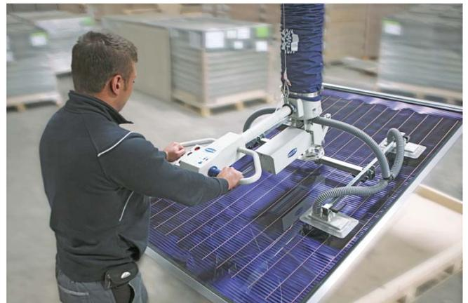
Vakuum-Schlauchheber JumboErgo bei der Handhabung von Modulen
