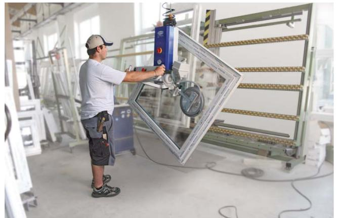
VacuMaster Window eingesetzt bei der Rahmenmontage von Fenstern
