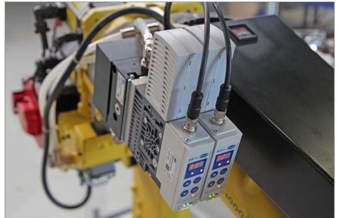
Kompaktejektoren X-Pump mit Energie- und Prozesskontrolle
