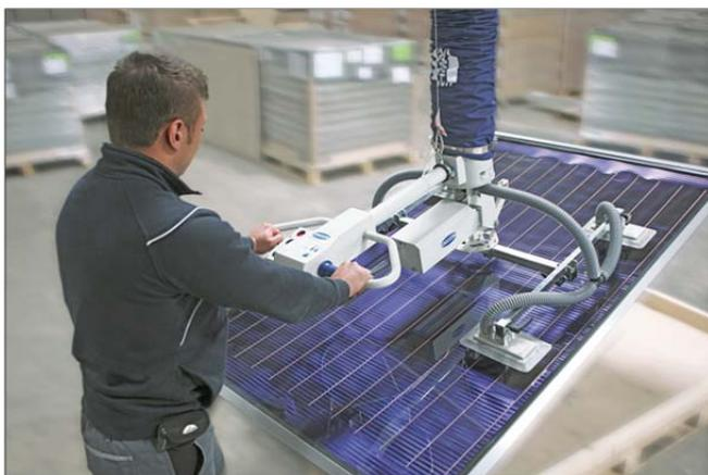
Vakuum-Schlauchheber JumboErgo bei der Handhabung von Modulen
