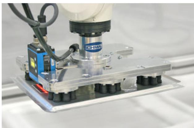
Kundenspezifische Vakuumgreifer zur sicheren Aufnahme und Positionierung von Pouchzellen in verschiedenen Formaten
