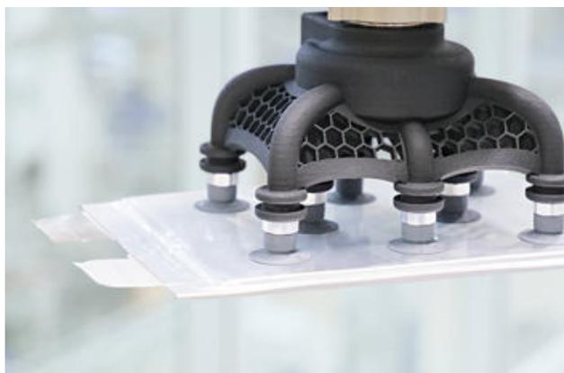
Leichtbaugreifer SLG mit strukturierten Sauggreifern SGPN zur schonenden Handhabung von Pouchzellen
