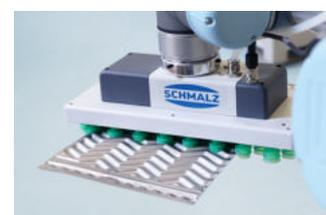
Handhabung von Batteriemodulen in der Packmontage
