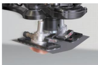
Handhabung von Elektroden und Separatoren in der Zellfertigung
