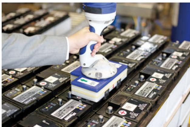
JumboFlex zur manuellen Handhabung von Batteriemodulen
