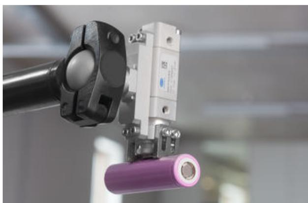
Magnetgreifer zur Handhabung von Hardcase-Zellen aus Stahl
