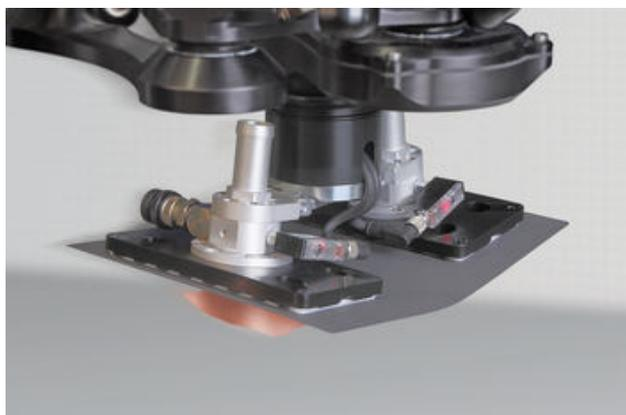
Spezialgreifer STGG bei der Handhabung von Anoden
