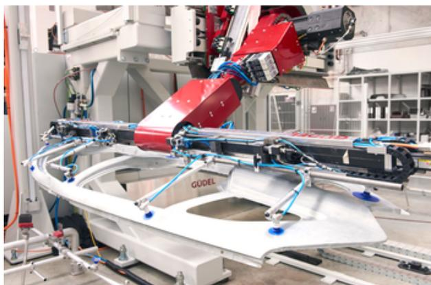
Glockensauggreifer SAX und Vakuumerzeuger SXMPi bei der Handhabung von Seitenteilen
