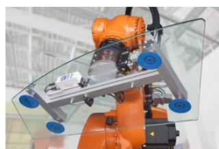
Handhabung von Bauteilen in der Fahrzeug-Endmontage
