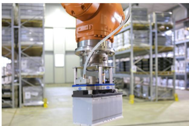
Flächensauggreifer FX-SV bei der Handhabung einer Starterbatterie
