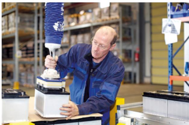
Vakuum-Schlauchheber JumboFlex bei der Handhabung von Starterbatterien in der Logistik
