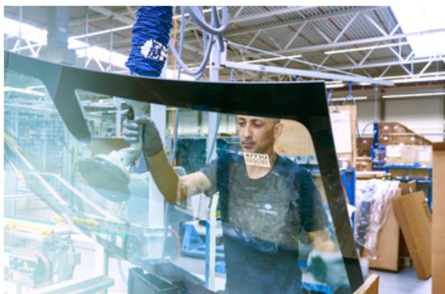
Vakuum-Schlauchheber JumboFlex bei der Handhabung von Windschutzscheiben
