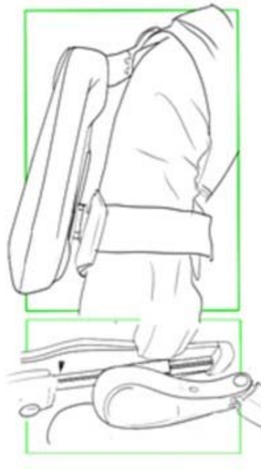
Fig. 6.1 - Detailansicht der Schlitten der TGB und der pDOFs
