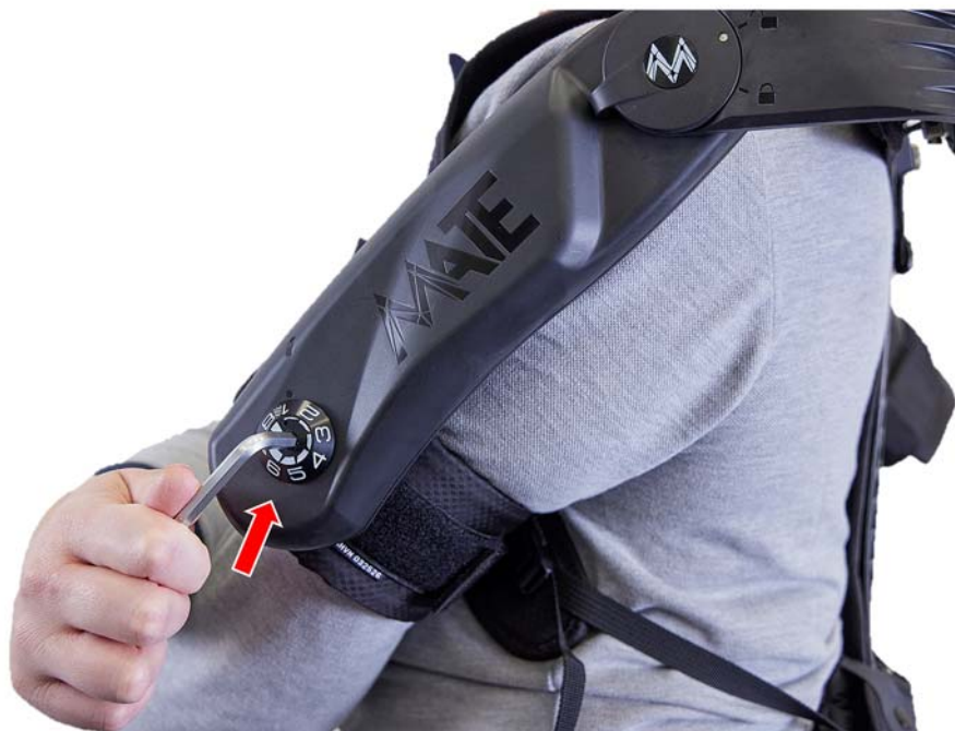
Abb. 4.3 - Nahansicht der Einstellvorrichtung an der Torque Generating Box und des Stufenanzeigers für das Unterstützungsniveau
