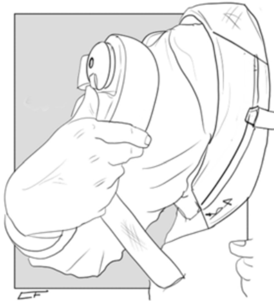
Abb. 5.14 - Verriegelung des Verriegelungsmechanismus der Torque Generating Box
