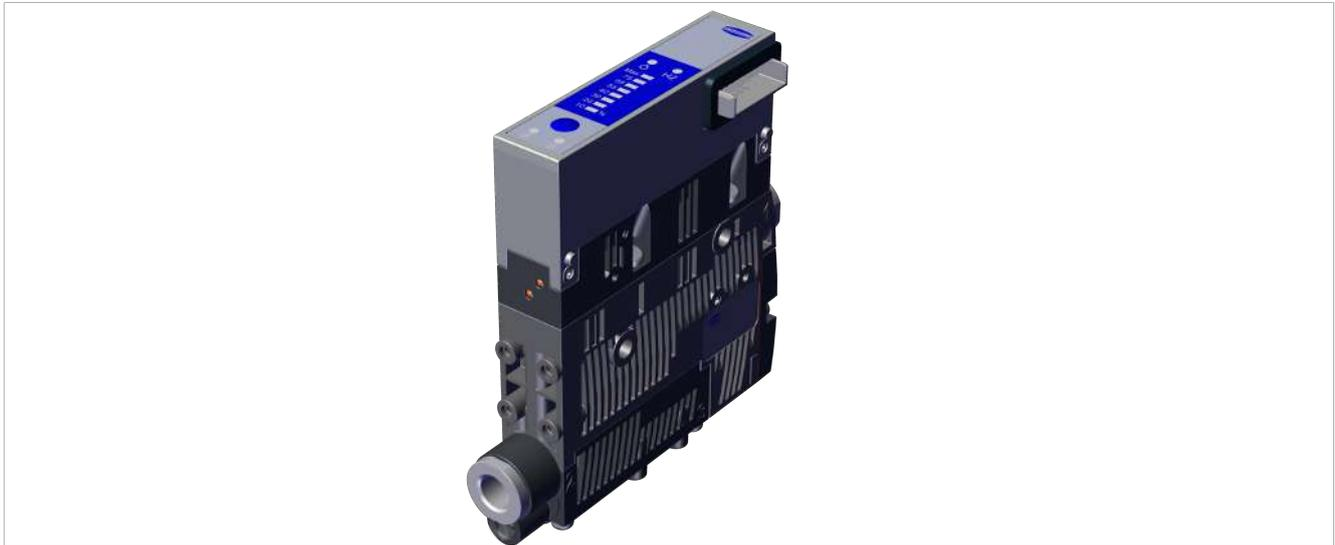
Das Vakuum wird, nach dem Venturi-Prinzip, durch eine Sogwirkung beschleunigter Druckluft in einer Düse erzeugt. Druckluft wird in den Ejektor eingeleitet und durchströmt die Düse. Unmittelbar nach der Treibdüse entsteht ein Unterdruck, wodurch die Luft durch den Vakuum-Anschluss angesaugt wird. Abgesaugte Luft und Druckluft treten gemeinsam über den Schalldämpfer bzw. den Abluftkanal aus.
